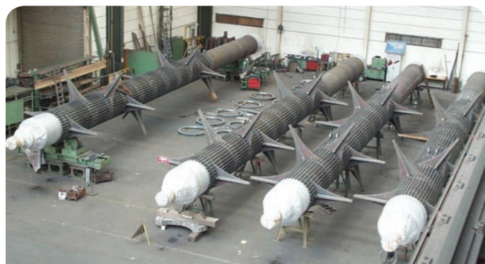
Rührwerke für MBA-Reaktoren (Länge ca. 26 m)
