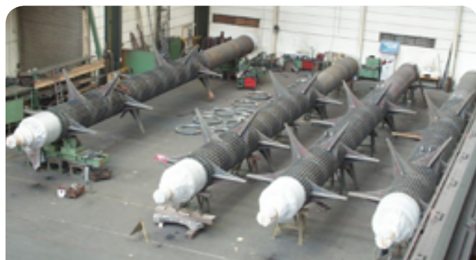
Rührwerke für MBA-Reaktoren (Länge ca. 26 m)
