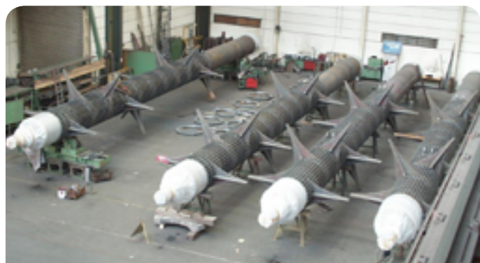
Rührwerke für MBA-Reaktoren (Länge ca. 26 m)
