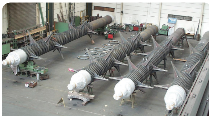
Des agitateurs pour des réacteurs TMB (longueur : environ 26 m)
