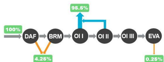
4) Chaîne de processus de l'usine ZLD ainsi que le pourcentage de produits finaux quittant le processus.
